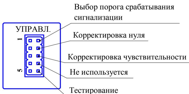
Рисунок 1.3 - Назначение контактов разъема "УПРАВЛ."
